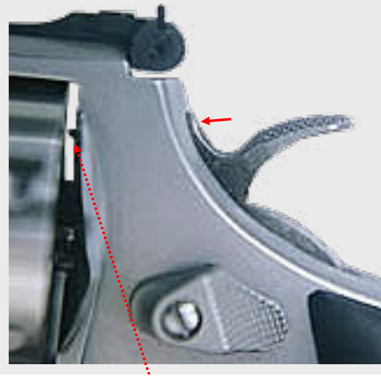
bei durchgezogenem Abzug auf dem Schlagbolzen aufliegend.
