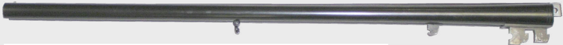
Ausgehängtes Laufpaar einer Doppelflinte.
