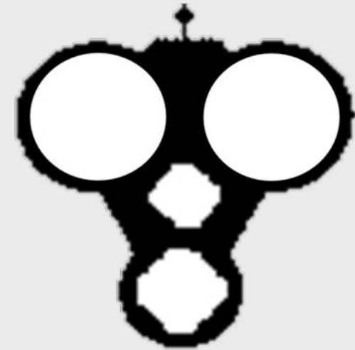
Vierling in T-Form (kleine Kugel in der Mitte der Verlötung).
